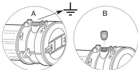
Si une entrée de câble n'est pas utilisée, ne pas oublier d'y monter le bouchon livré dans le sachet (B).
